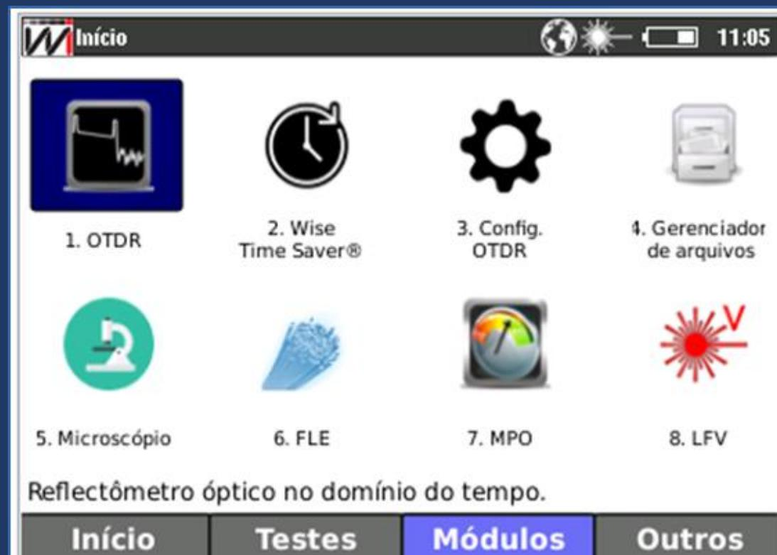
O TSW150-OTDR possui 6 módulos para tornar simples e prática a operação do equipamento. Os módulos são:
