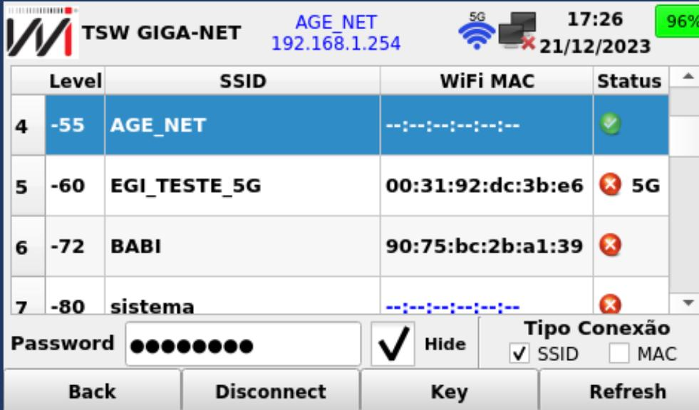
O TSW GIGA-NET permite que na seleção da rede WiFi para teste, se escolha o Tipo de Conexão, via SSID ou via MAC. Esta função é muito importante, pois no teste de Pontos de Acesso configurados para Band Steering, ou de Redes Mesh, é possível escolher o rádio no qual o teste será realizado (Conexão via MAC).
